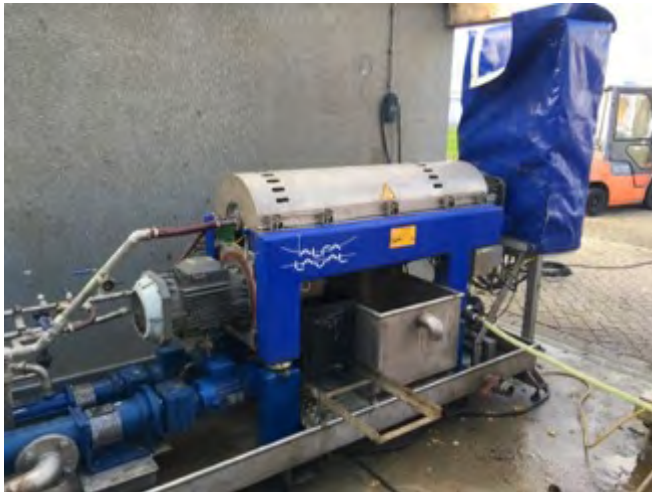
FIGUUR 20 DECANTEERCENTRIFUGE VAN 300 L/H VAN ALFA LAVAL
