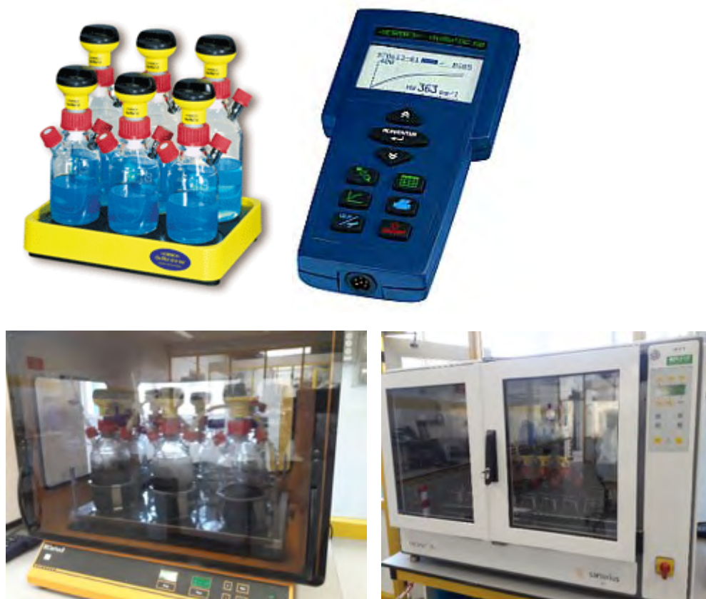
FIGUUR 6 DETAILS VAN DE OXYTOP TESTFLESSEN (LINKER BOVENZIJDJE) MEETAPPARATUUR (RECHTER BOVENZIJDJE) EN DE TEMPERATUURGESTUURDE INCUBATORS (ONDERZIJDJE)
