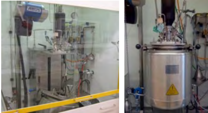
FIGUUR 4 AUTOCLAAF OPSTELLING EN VOORAANZICHT VAN DE 20-L AUTOCLAAF
