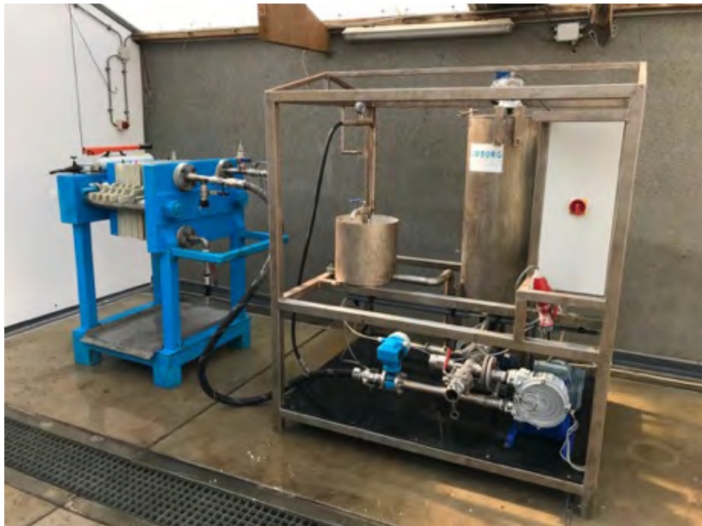
MEMBRAANFILTERPERS (LINKS) EN SLIBPOMPSTATION (RECHTS) VAN LIMBURGFILTER B.V.
