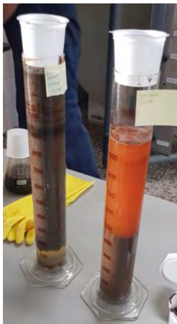
FIGUUR 17 MAATCILINDERS DIE HET GEDRAG VAN VASTE STOFFEN IN ZUIVERINGSSLIB DEMONSTREREN. LINKS: RUW SLIB VÓÓR TORWASH®; RECHTS: SLIB NA TORWASH®. DE ORANJE KLEUR VAN DE VLOEISTOF IS NIET REPRESENTATIEF – HET VOCHT IS BIJNA ALTIJD BRUIN – MAAR DEZE FOTO MAAKT HET EFFECT WEL EXTRA GOED ZICHTBAAR
