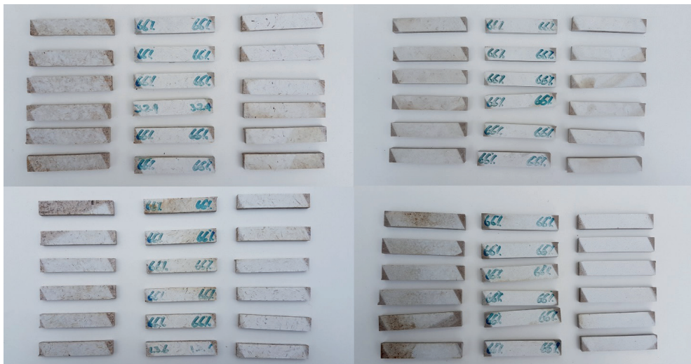
FIGUUR 10 VEROUDERINGSPROCES VAN DE SAMPLES MET GRAS, CELLULOSE, RIET EN WATERPLANTEN. DE ZICHTBARE RIJEN ZIJN NA 700 UUR, 1400 UUR EN 2100 UUR IN EEN QUV-KAST
